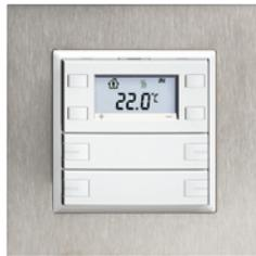
Der EDIZIOdue colore KNX-Hotelcard-Schalter: mit bis zu 16 Schaltkanälen unabhängig voneinander schaltbar, mit early-return-Funktion und mit Szenenschaltungen.
