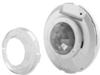
Mittels einer Reduktion kann der Erfassungsbereich der pirios 360 eingeschränkt werden. Reduktions-Set 44360.SET. Auch zu verwenden bei Präsenzmelder pirios 360P und Präsenzmelder pirios 360P KL mit Konstantlichtregelung.
