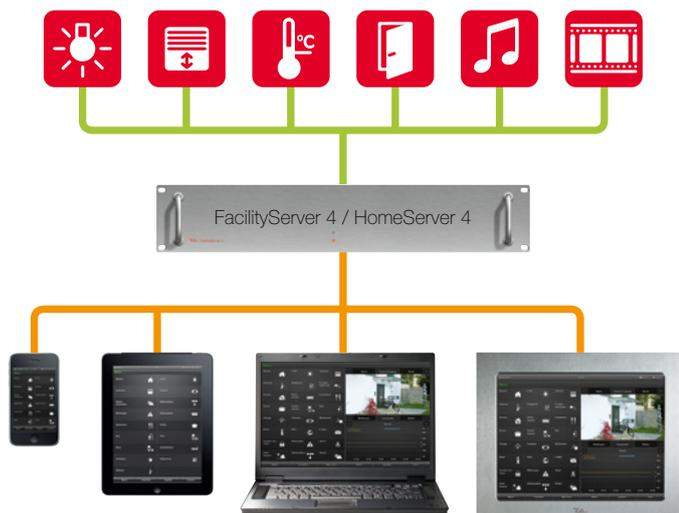
Mit der Interface-App der Feller AG kann die gesamte KNX-Gebäudetechnik auch bequem mit iPhone, iPod touch oder iPad bedient werden. Das Interface stellt alle Funktionen übersichtlich dar und ermöglicht den schnellen Zugriff auf die Gebäudetechnik auch von unterwegs.
