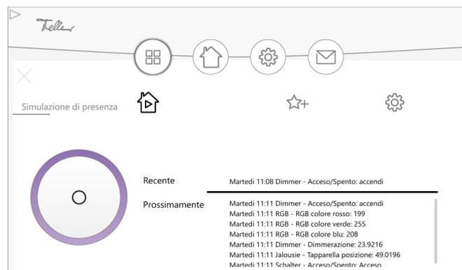
Se la simulazione di presenza è avviata, qui è possibile vedere l'ultima azione eseguita e quale immediatamente successiva.
