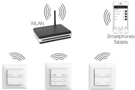
Das WLAN-Zwischenmodul wird zwischen zeprion Einsatz (ab Produktionsjahr 2008) und Abdeckset (klassisches zeprion oder zeprionAIR) montiert.
