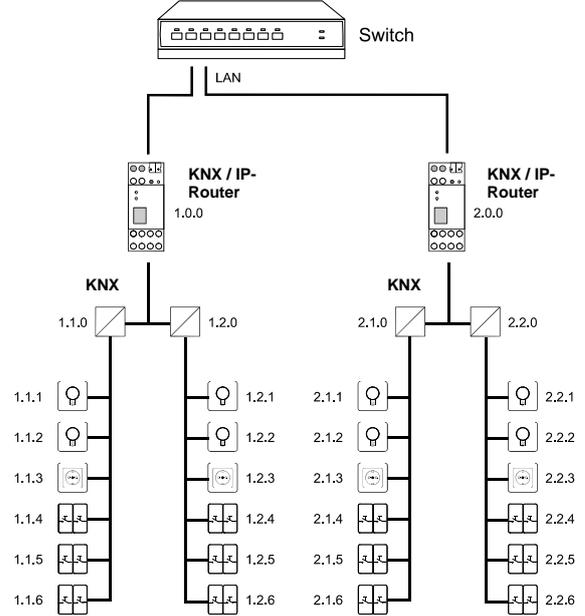
KNX / IP-Router als Schnittstelle für eine Visualisierung mit dem FacilityServer / HomeServer
