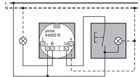
Il est possible de raccorder jusqu'à 10 appareils à la station principal (p.ex. 3 stations secondaires et 7 poussoirs zeption)! Le nombre de poussoirs classiques est illimité.
