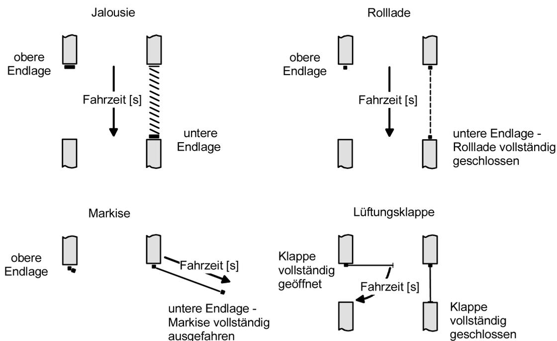
Bild 8: Ermittlung der Fahrzeit in Abhängigkeit der Antriebsart
