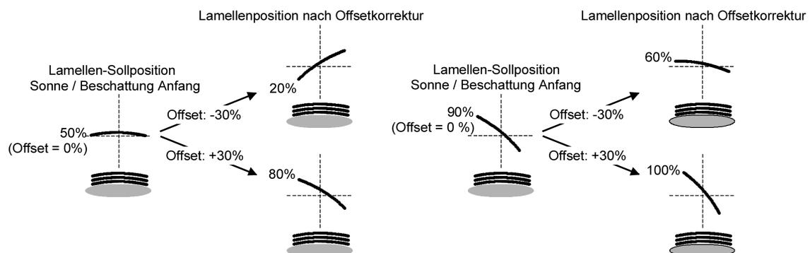
Bild 21: Funktionsweise des Lamellenoffsets als Beispiel
