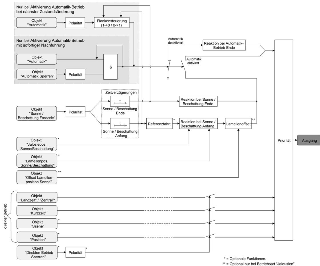
Bild 20: Funktionsschaltbild des erweiterten Sonnenschutzes
