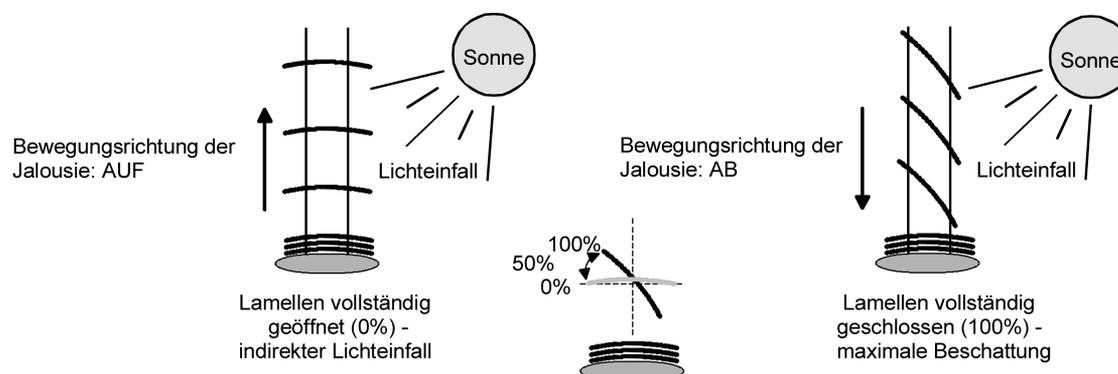
Bild 10: Typ 2 - Lamellenjalousien mit schräger und gerader Lamellenstellung
