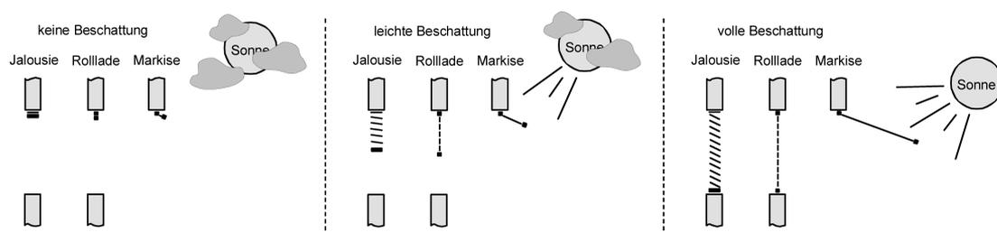
Bild 16: Prinzip eines Sonnenschutzes (Beispiele)
