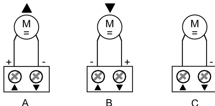
Bild 3: Polung an den Antriebsmotoren in Abhängigkeit der Fahrtrichtung (A und B) und bei gestopptem Antriebs (C).
