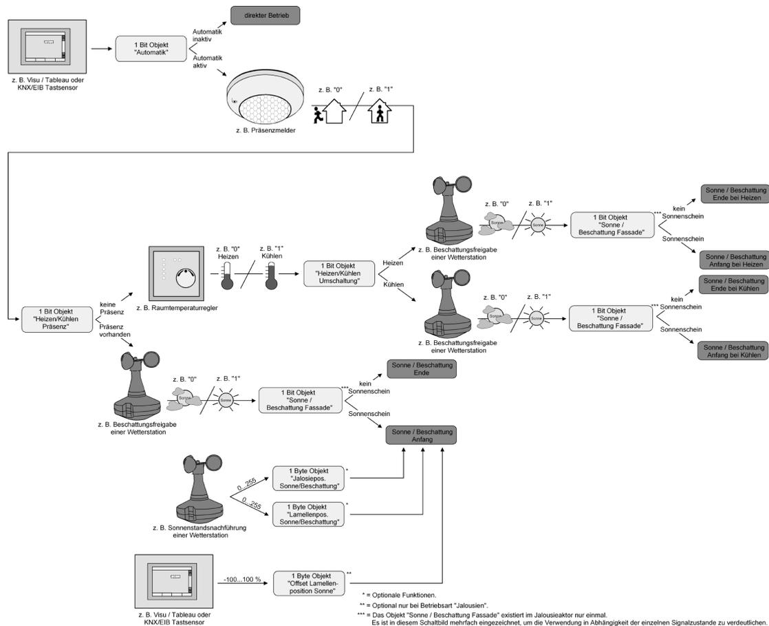
Bild 22: Prinzipschaltbild der Heizen/Kühlen-Automatik (zur Vereinfachung ohne Sperrfunktionen des Automatik-Betriebs oder des direkten Betriebs)
