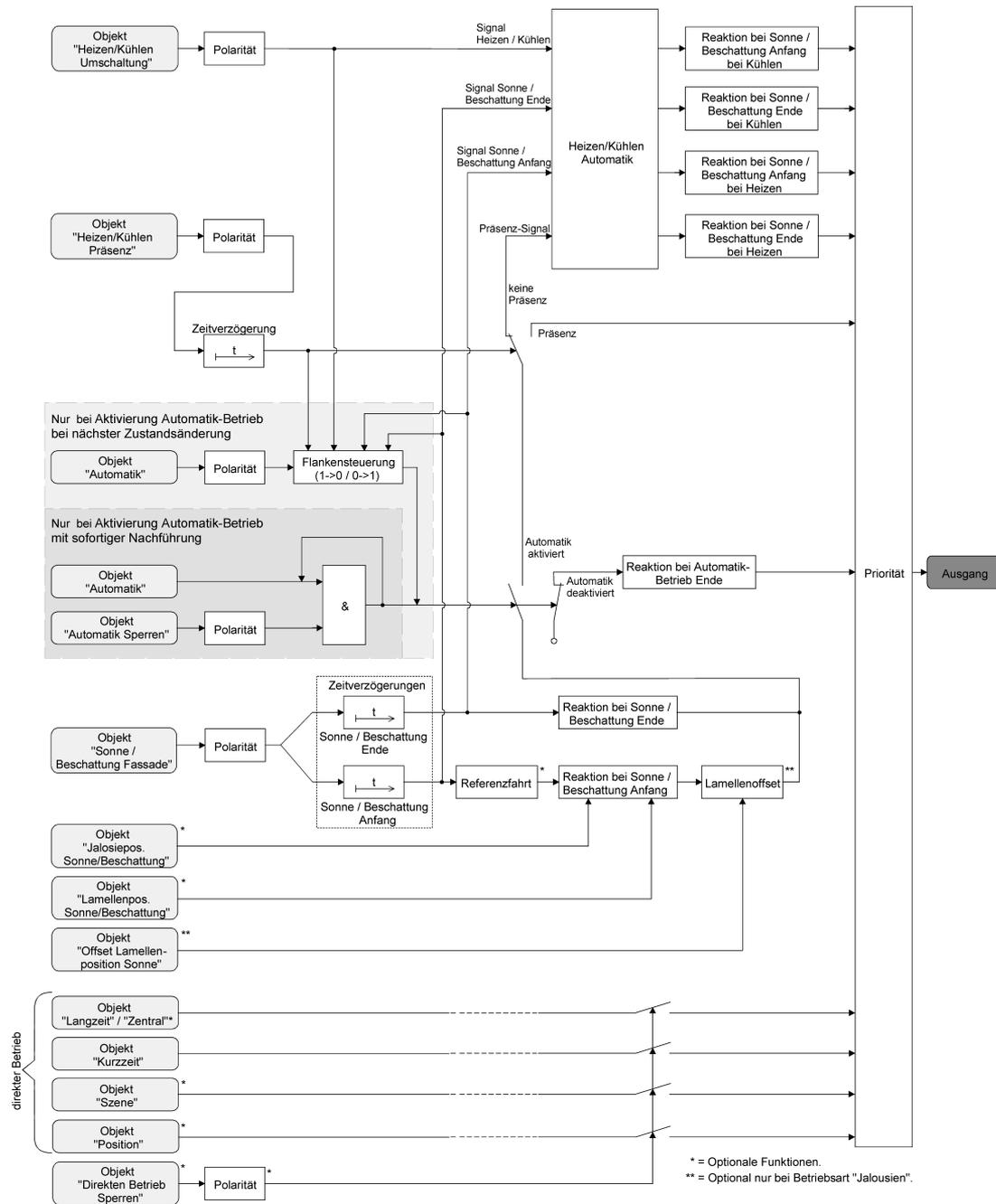
Bild 23: Funktionsschaltbild der Heizen/Kühlen-Automatik
