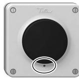
Lors de l'installation des poussoirs/interrupteurs, veiller à ce que l'orifice d'évacuation d'eau se trouve en bas.
