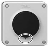
Achten Sie beim Einbau von Tastern/Schaltern darauf, dass das Entwässerungsloch der Abdeckung unten ist.
