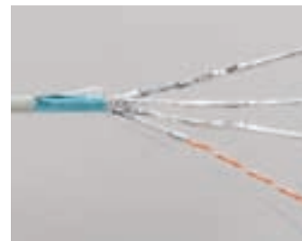
Das dirigon-Twisted-Pair-Kabel (vier paarweise verdrehte und geschirmte Adernpaare mit dreifacher Gesamtschirmung des Gesamtkabels) für alle Medien.
