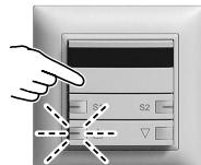
La disattivazione del modo inizializzazione avviene automaticamente se nei successivi 3 minuti il trasmettitore IR non emette più istruzioni o premendo nuovamente per un breve istante il pulsante di inizializzazione. Il LED di programmazione si spegne; rimane impostato il vecchio indirizzo IR.
