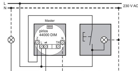
Fig. 3 Tasterfunktion Retrigger
