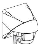
Se necessario, l'angolo di rivelamento può essere ulteriormente ridotto mediante i riduttori compresi nella fornitura.
