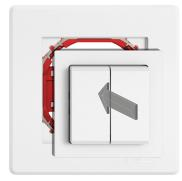
3. Insérez l'appareil jusqu'à l'enclenchement des ressorts de maintien.
