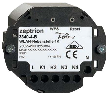
Die zeprion WLAN-Nebenstelle verfügt über 4 Kanäle und verbindet bis zu vier angeschlossene zeprion Hauptstellen mit einem Wireless Netzwerk (WLAN). So können die angeschlossenen Hauptstellen über die Feller zeprion App angesteuert werden und ermöglichen eine mobile Fernbedienung von zeprion mit Smartphones und Tablets.
