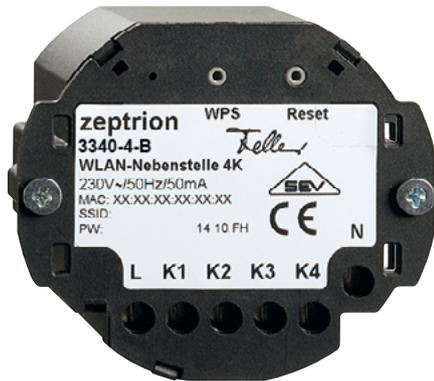
La station secondaire WLAN zeprion dispose de 4 canaux et peut connecter jusqu'à 4 stations principales zeprion à un réseau sans fil (WLAN). Les stations principales qui lui sont reliées peuvent ainsi être pilotées via l'appli Feller zeprion et être commandées à distance dans le cadre d'une utilisation mobile depuis un smartphone ou une tablette.
