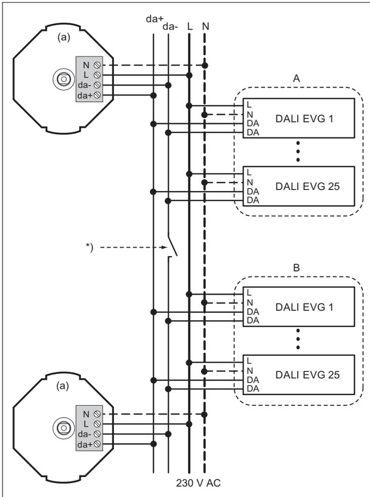
Schema für teilbaren Raum mit je einem aktiven (a) DALI Power-Drehgeber für je maximal bis zu 25 DALI EVG. Pro Raum könnte auch noch optional ein passiver DALI Power-Drehgeber installiert werden (nicht gezeichnet).
