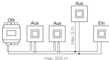
Il collegamento degli apparecchi sul bus deve essere in serie. La lunghezza massima di una linea non deve superare **500 m**. Non è ammessa la struttura a stella. Dovendo realizzare una linea derivata per un apparecchio, questa non deve superare **5 m** di lunghezza.
