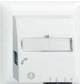
Die DIAMOND F-3000™ Mittelstücke mit Laser- und Staubschutzklappe sind mit dem gängigen Standard LC (IEC 61754-20/ED1) kompatibel. Sie erlauben ein einfaches Anschliessen von bis zu vier Singlemode-Verbindern. Im Innern wird die Anschlussdose mit der Faser G.657.A aufgeschaltet. Sie weist optional geschaltete RJ45-Kupferanschlüsse (T+T/DSL) auf.
