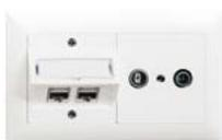
In einer Anschlussdose werden bis zu zwei dirigon RJ45-Buchsen montiert. In Räumen, wo Radio/TV-Empfang vorgesehen ist, werden dirigon Anschlussdosen in 2er-Kombinationen mit CATV- oder SAT-Dosen von WISI installiert. Für die Verteilung von IPTV ist keine koaxiale Verkabelung nötig.
