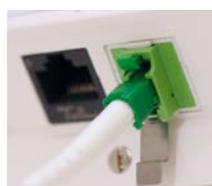
Relier ensuite le modem fibre optique à la prise fibre optique S-One. C'est terminé!
