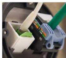
Pas d'épissure nécessaire. Il suffit simplement d'insérer le connecteur DiaLink dans l'adaptateur S-One: c'est simple et rapide! (photo: face arrière du kit de montage)
