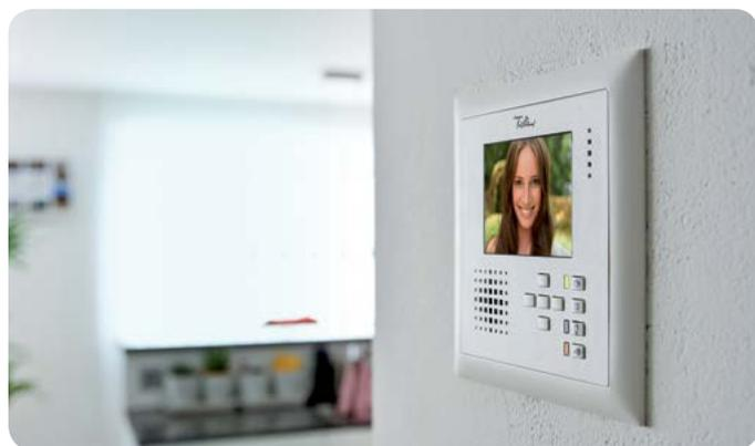
L'integrazione del citofono interno nell'assortimento sotto intonaco Feller EDIZIOdue e STANDARDdue offre vantaggi essenziali anche per la progettazione e la coordinazione. I citofoni interni si possono piazzare nelle usuali scatole di grandezza 1 (audio 1+1, video 2+2) e si possono quindi montare esattamente come dei tradizionali apparecchi sotto intonaco Feller.
