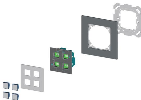
Les poussoirs sont livrés avec des touches provisoires. Le set de recouvrement EDIZIOdue elegance est livré et monté séparément par la suite. Jusque là, le poussoir peut être intégré et utilisé avec les touches provisoires.
