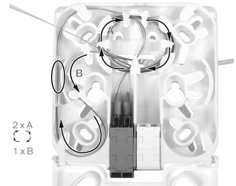
Legen Sie die Fasern der Pigtails wieder ein (1 x A, 3 x B, 1 x C) ohne die Pigtails vom Mittelstück zu entfernen.
