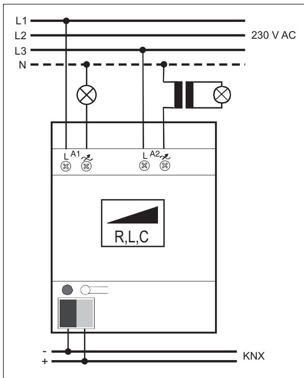
Der Anschluss verschiedener Außenleiter an A1 und A2 sowie zeitgleicher Betrieb von kapazitiven oder ohmschen Lasten an z. B. Kanal 1 und induktiven Lasten an z. B. Kanal 2 ist möglich
