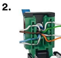
2. Placer les différents fils dans le dispositif pour câbles et couper les extrémités de fils à la bonne longueur.
