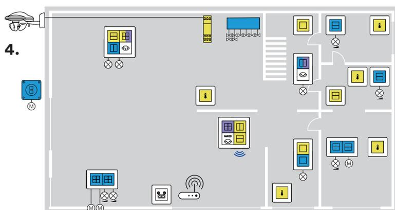
Per la gestione con l'app Wiser Home, stabilire la posizione dell'**apparecchio WLAN**.
