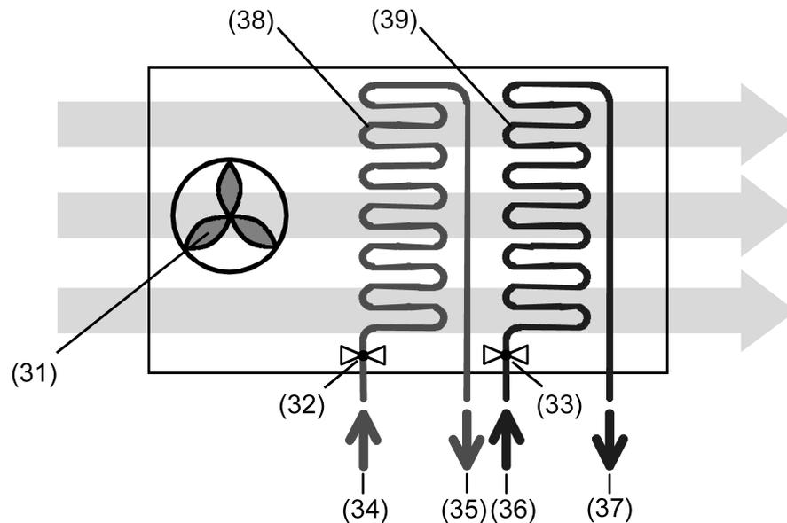
Bild 9: Das 4-Rohr-System
