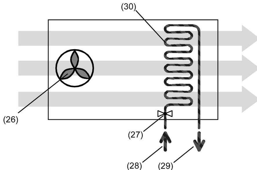
Bild 8: Das 2-Rohr-System
