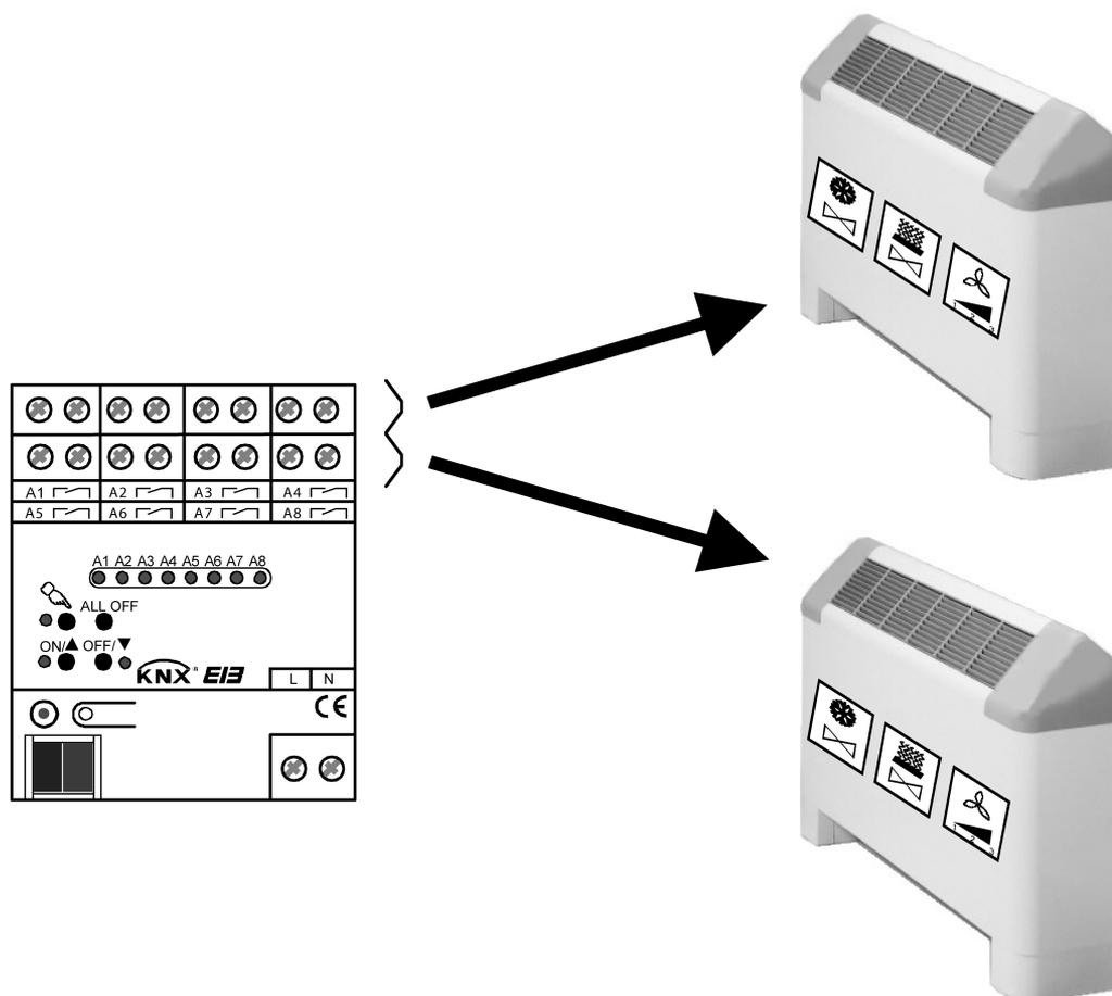
Bild 11: Der 2-Kanal-Betrieb
