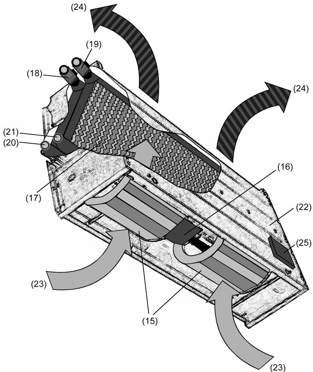
Bild 7: Das FanCoil-Prinzip (Beispiel an einem 4-Rohr Gebläsekonvektor in Standbauform)
