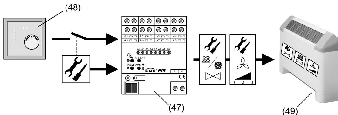
Bild 32: Prinzip der Sperrfunktion am Beispiel einer Wartungsverriegelung
