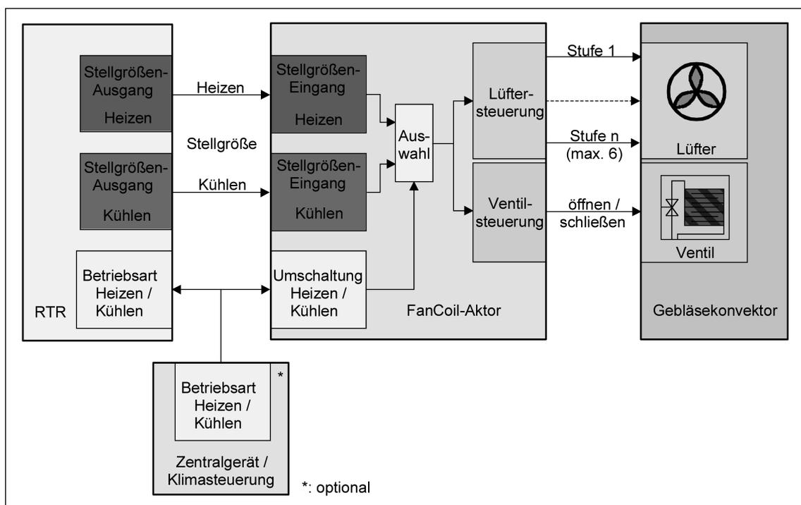
Bild 13: Funktionsschema "2-Rohr Heizen/Kühlen über Umschaltobjekt"
