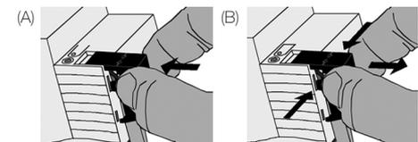
Dopo aver collegato la linea bus: per proteggere il collegamento a bus da pericolose tensioni nell'area di connessione, inserire il cappuccio (A):
