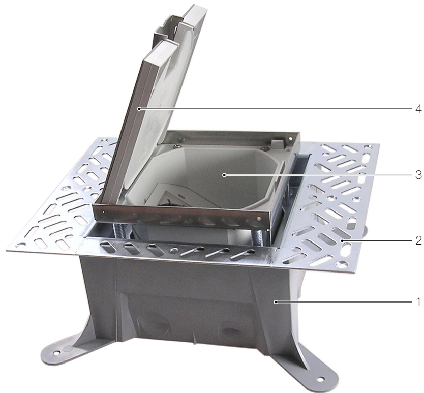
fig. 3 Parties de la boîte de sol 1 Boîte d'encastrement (→ chapitre 4.2 ) 2 Cadre porteur (→ chapitre 4.3 ) 3 Cuvette (→ chapitre 4.4 ) 4 Couvercle à charnière ou rapporté (→ chapitre 4.5 )
