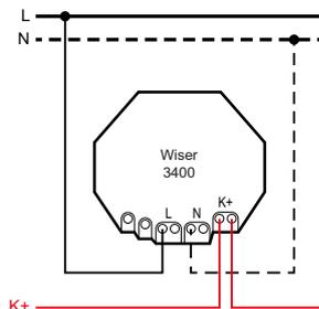
L Conduttore polare (230 V AC, 50 Hz)
