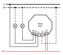
Geregelter/geschalteter Ausgang Aussenleiter (230 V AC, 50 Hz) Ν Neutralleiter Kommunikationsdraht K+ K+
