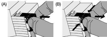
Nach Anschluss der Busleitung: Um den Busanschluss vor gefährlicher Spannung im Anschlussbereich zu schützen, Abdeckkappe aufstecken (A):
