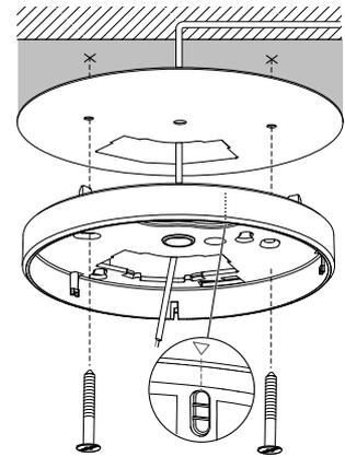
2. Befestigen Sie die Montagefolie und den Montagesockel mit den zwei Schrauben an der Decke. Führen Sie ggf. die 2-Draht-Leitung durch die vorbereitete Öffnung in der Montagefolie.
