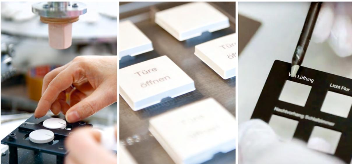
Ob mit Laser, Lasergravur und Farbauslegung, Tampondruck oder Heissprägung – die Ergebnisse aus der topmodernen Feller Beschriftungsabteilung gewährleisten eine durchgängig konsequente und hochwertige Designsprache.
