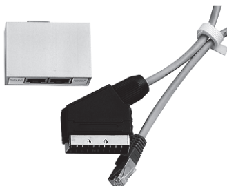
fig. 30 Adaptateur vidéo/audio composite (1120-AS1002S00)
