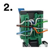
Die einzelnen Drähte in die Kabelvorrichtung einlegen und die Kabelenden auf die korrekte Länge zuschneiden.
