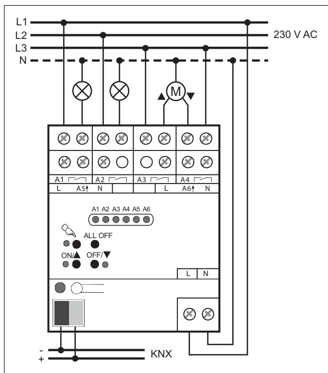
Sollen mehrere Antriebe an einem Ausgang parallelgeschaltet werden, unbedingt Angaben der Hersteller beachten, gegebenenfalls Trennrelais verwenden. Andernfalls könnten die Antriebe zerstört werden.
