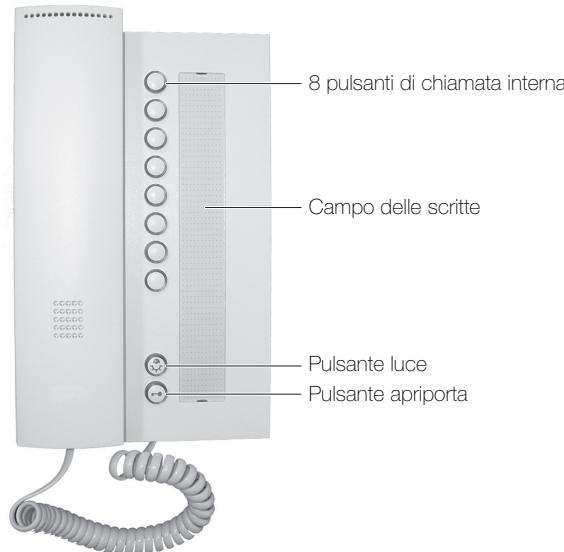
Con il vostro telefono è possibile parlare (chiamata alla porta) ed azionare l'apriporta con una persona sulla porta di casa (citofono esterno). A seconda della versione dell'impianto è possibile commutare anche la luce (vano scale) e/o telefonare con altre utenze dell'impianto citofono (chiamata interna).
