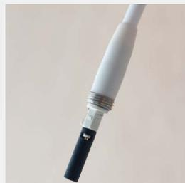
Durch drehen der Kappe im Gegenuhrzeigersinn wird der DiaLink-Stecker freigelegt und ist nun bereit für den Anschluss.
