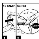
Das patentierte zweistufige Feller SNAPFIX® Befestigungssystem vereinfacht die Arbeit und reduziert Fehlerquellen. Die Montage und die Demontage lassen sich von vorne durchführen, was das Auswechseln von Funktionen deutlich erleichtert.
