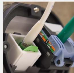
Kein Spleissen nötig. Einfach den DiaLink-Stecker in den S-One Adapter einstecken: so schnell und so einfach! (Bild zeigt Rückseite des Montage-Sets).
