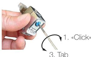
1. Ruotare con un giravite il potenziometro in senso orario finché si sente la battuta o si sente un «Click». Questo è il livello massimo.
