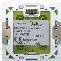
Dietro il kit di copertura si trova il commutatore per l'illuminazione d'orientamento, rispettivamente per l'illuminazione dello stato di funzionamento (a sinistra indicatore dello stato/controllo, a destra illuminazione d'orientamento).
