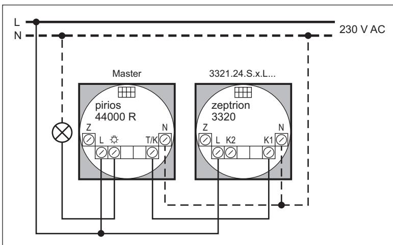
An einen Master dürfen maximal 10 **zeptrion**-Taster angeschlossen werden!
