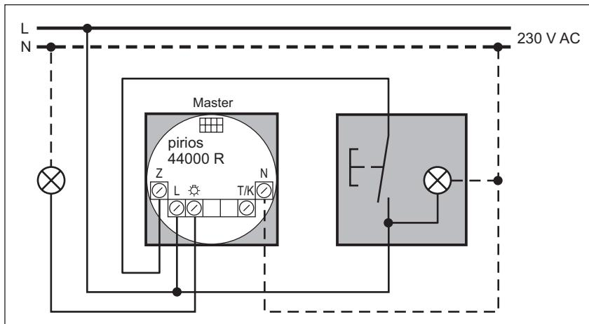
Beim Einsatz von beleuchteten Tastern ist der Typ 7563.ARK... zu verwenden. Die Beleuchtung des Tasters ist über einen separaten Stromkreis zu führen.
