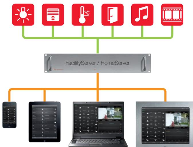
Toute la technique de bâtiment KNX peut aussi être commandée confortablement par un iPhone, un iPod touch ou un iPad via l'app d'interface de Feller SA. L'interface affiche clairement toutes les fonctions et permet un accès mobile à la technique de bâtiment.
