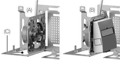
3b. Comme alternative, un appareil encastrable FLF peut être monté à l'emplacement de montage FLF (C).
