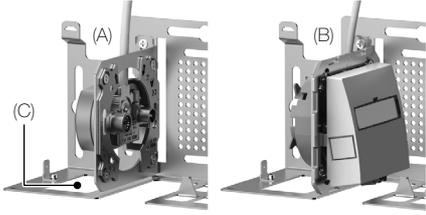
3b. Als Alternative kann am FLF-Einbauplatz (C) ein FLF-Einbauparagraf montiert werden.
