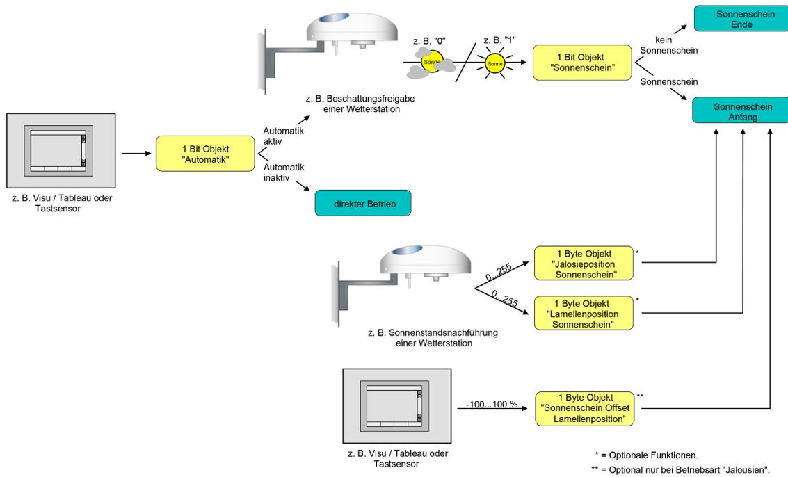
Bild 16: Prinzipschaltbild des erweiterten Sonnenschutzes
