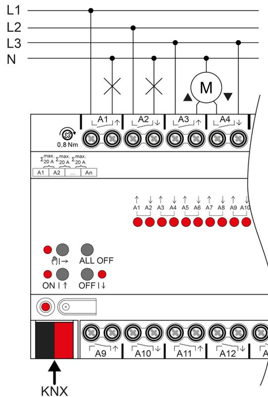
Bild 2: Geräteanschluss (Anschlussbeispiel)
