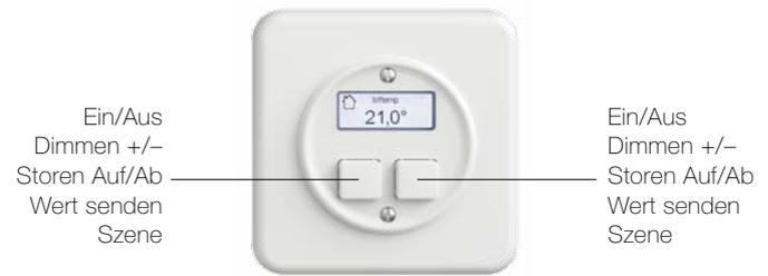
**Hinweis:** Tasten zum Bedienen des Raumthermostats. Durch Drücken einer Taste wird der angezeigte Wert (wenn einstellbar) verändert. Durch gleichzeitiges Drücken beider Tasten wird zwischen den verschiedenen Wertanzeigen umgeschaltet. Sind die Tasten zum Bedienen von beliebigen Verbrauchern (Licht, Storen etc.) konfiguriert worden, dient das LC-Display als reine Anzeige und Sie können den Raumthermostaten lokal nicht bedienen.
