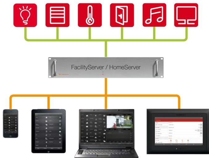
Mit der Interface-App von Feller kann die gesamte KNX-Gebäudetechnik auch bequem mit iPhone, iPod touch oder iPad bedient werden. Das Interface stellt alle Funktionen übersichtlich dar und ermöglicht den schnellen Zugriff auf die Gebäudetechnik auch von unterwegs.
