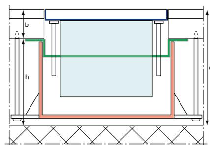
Montando la presa da pavimento in sottofondi cavi, deve essere ordinato a parte l'assortimento di viti per montaggio su sottofondo cavo (934-BDV).
