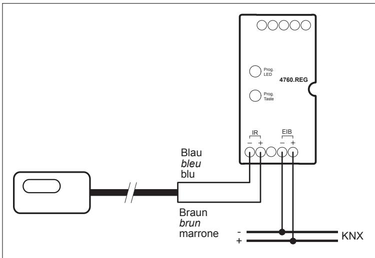
An einem Modul können bis zu vier IR-Augen angeschlossen werden. Maximal 10 Module können zu einem IR-Augen-Verbund (mit max. 40 IRAugen) verbunden werden.
